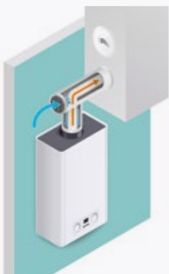
SCHÉMA 3 : VENTILATION NATURELLE PAR BALAYAGE - BOUCHE BASSE PRESSION
