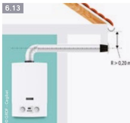
La longueur totale des conduits d'amenée et d'évacuation des produits de combustion doit être inférieure ou égale à la longueur de raccordement maximale admissible par l'appareil.
