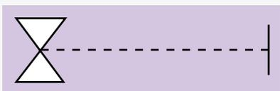
Par ailleurs, l'utilisation du symbole ci-contre représente un organe de coupure de site placé dans le local de production d'énergie, rendu manœuvrable de l'extérieur par un système approprié qui peut être :
