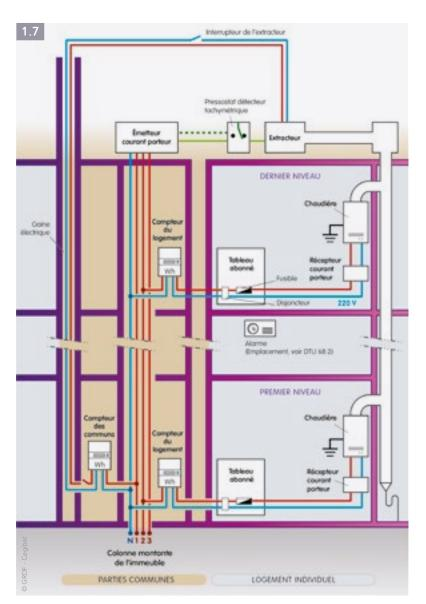
Le Dispositif de Sécurité Collective a pour but d'arrêter les appareils à gaz raccordés à une installation de VMC-Gaz en cas de détection d'un dysfonctionnement de l'extracteur, et éviter ainsi que les produits de combustion d'un appareil en fonctionnement ne refoulent aux étages supérieurs.
