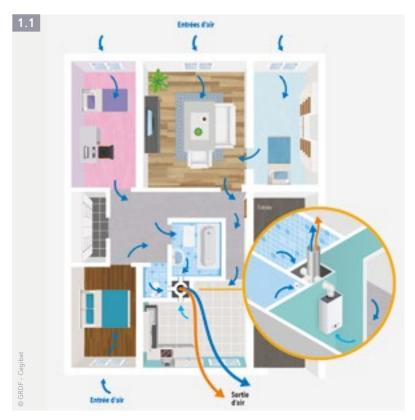
L'air neuf entre par les entrées d'air des pièces principales puis transite sous et autour des portes. L'air vicié est aspiré par des bouches d'extraction situées dans les pièces de service vers un ou plusieurs conduits collectifs. La dépression nécessaire aux bouches d'extraction est assurée par un extracteur situé généralement en terrasse ou en comble.
