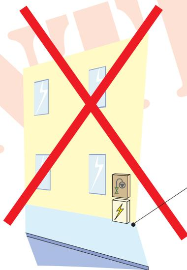
**⊘** L'alimentation de plusieurs pavillons à partir d'un regroupement de coffrets ou d'un placard technique équipé à l'entrée d'un lotissement est interdite.
