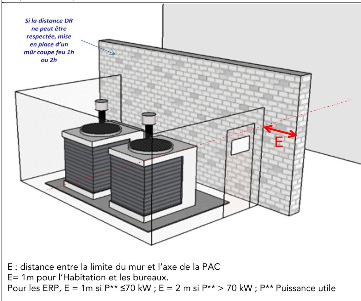
Si les pompes à chaleur sont accolées à la parois de l'immeuble qu'elle desservent, ou placées à moins de 2 m, cette partie de la façade doit respecter les mêmes caractéristiques que le mur de protection (dimension et résistance au feu) si  $P < 70$  kW.
