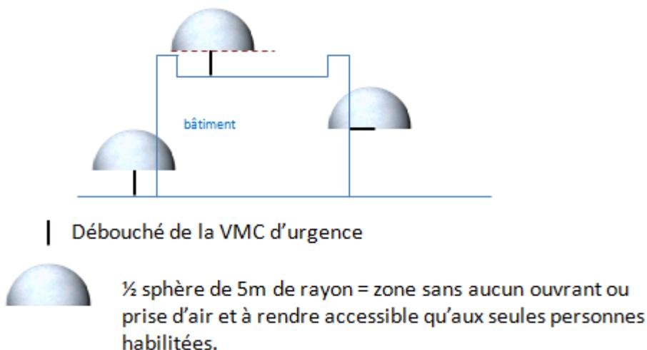
La soupape ammoniac doit être tubée jusqu'à l'extérieur, uniquement via le conduit de ventilation d'urgence.
