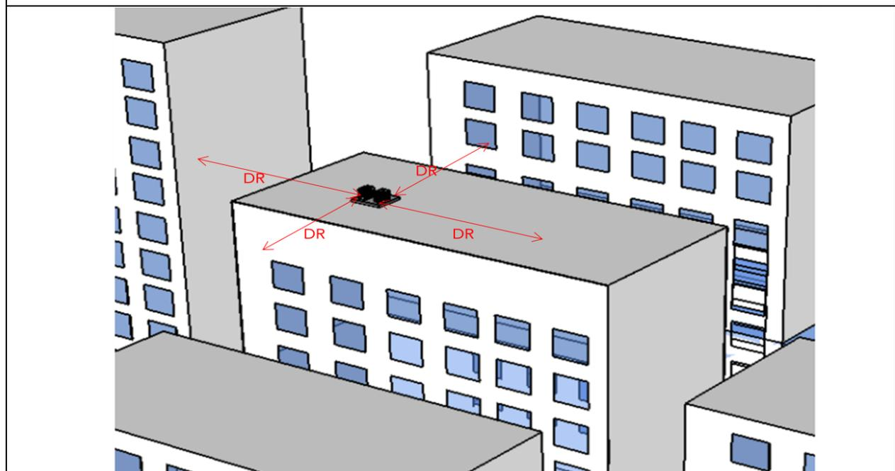
Figure 1.4 : Illustration avec mise en place d'un mur coupe feu si une distance (DR) ne peut être respectée.
