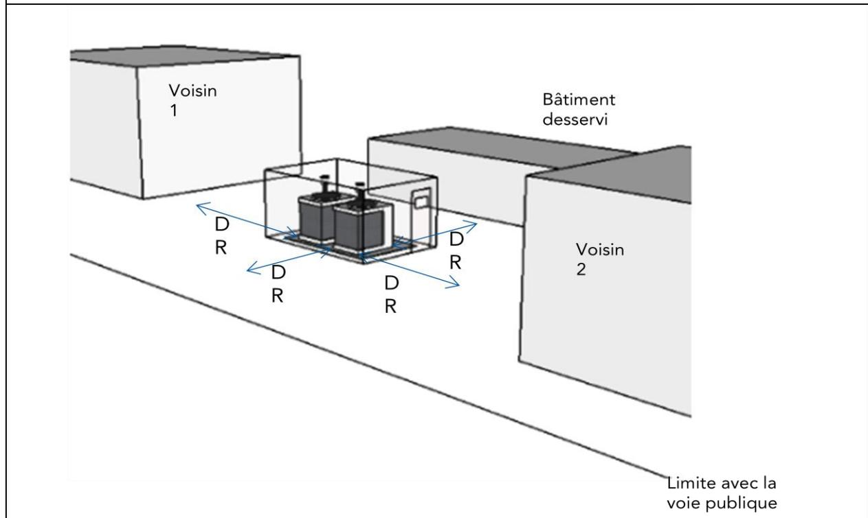
Figure 1.3 : Illustration de la distance DR à respecter lors d'une implantation en terrasse
