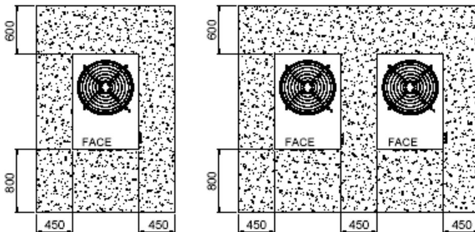
Figure 1.2 : Illustration de la distance DR à respecter lors d'une implantation au sol
