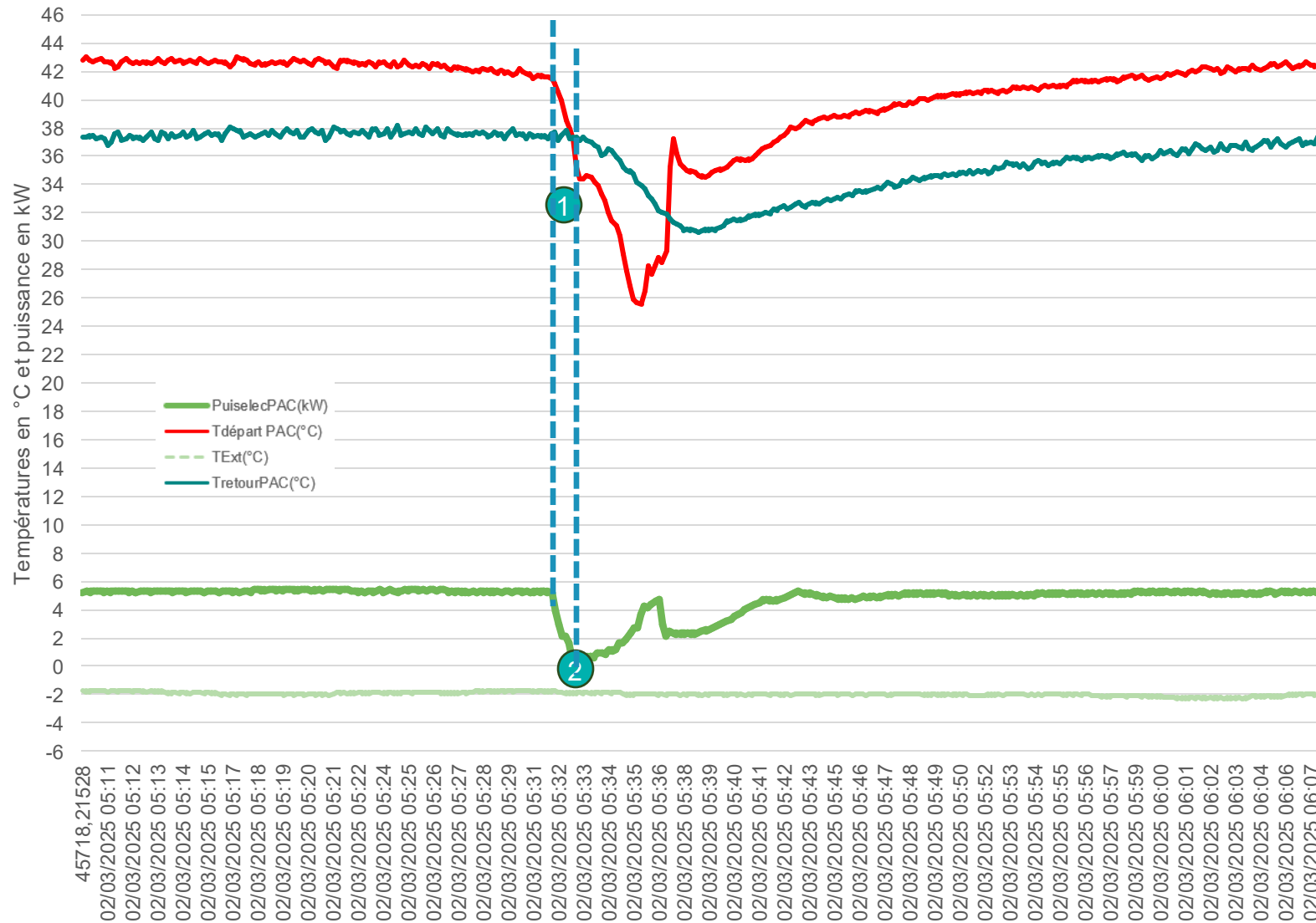
Fonctionnement de la PAC par journée froide avec dégivrage le 2 mars 20
