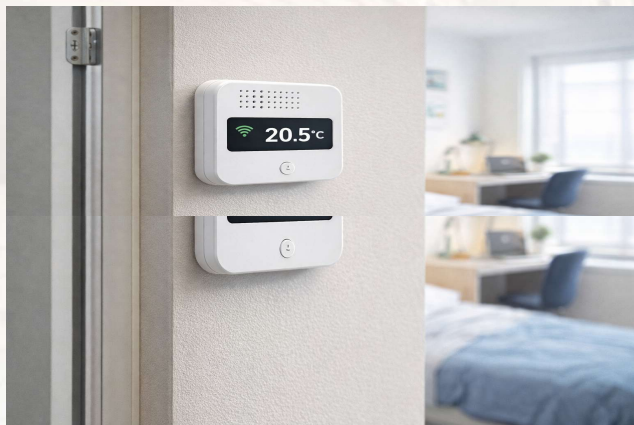
Mini-boîtier dans chaque logement température + présence
