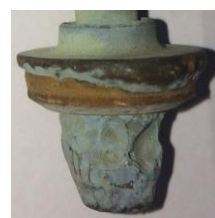
Section de passage au niveau de l'obturateur vanne presque fermée
