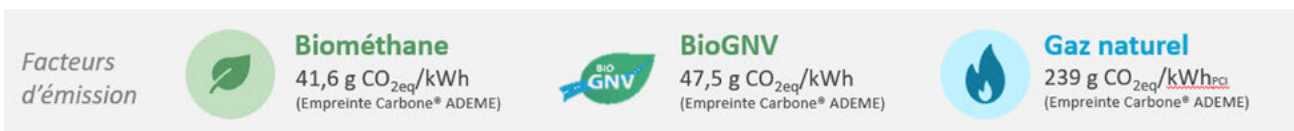
Figure 2 : Facteurs d'émission du biométhane, du bioGNV et du gaz naturel
