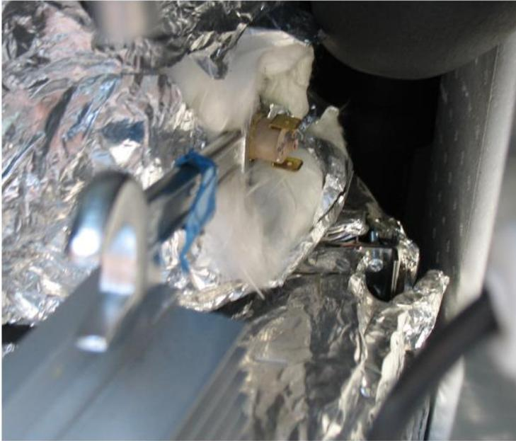
Bien que l'accès ne soit pas aisé, il n'y a pas besoin de retirer la résistance chauffante du souffleur et du bloc gaz.
