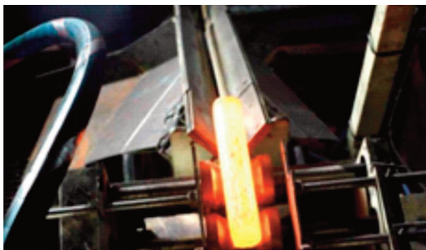
Chauffage par induction.
